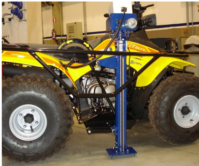
Foto 2: Alavanca travada na posição "Serviço"
