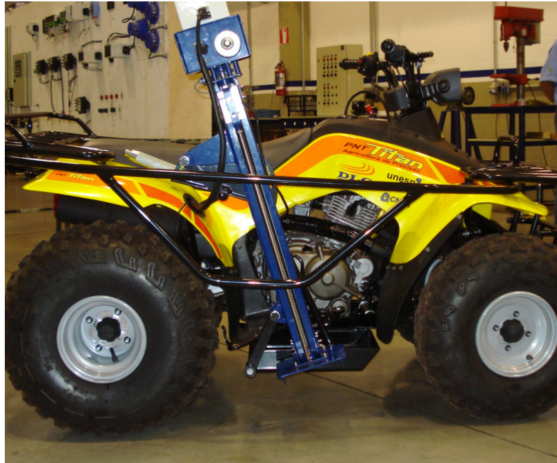
Foto 3: Alavanca travada na posição "Transporte"
