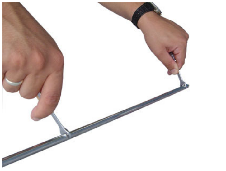
Figura 8 - Conexão das Hastes
