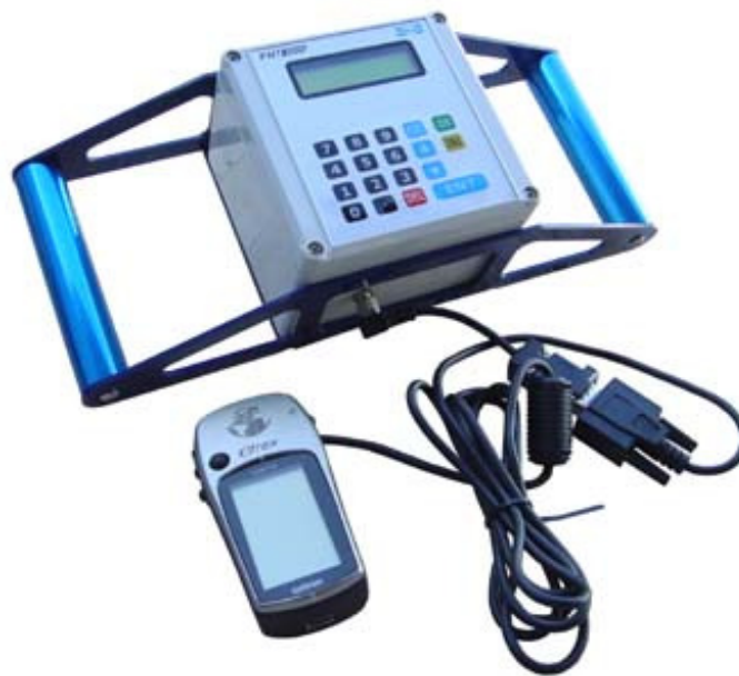
Figura 10 - Interligação do PNT ao GPS
