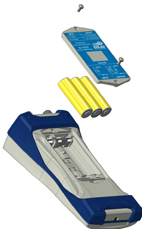
Figura 25 – Troca das baterias.
